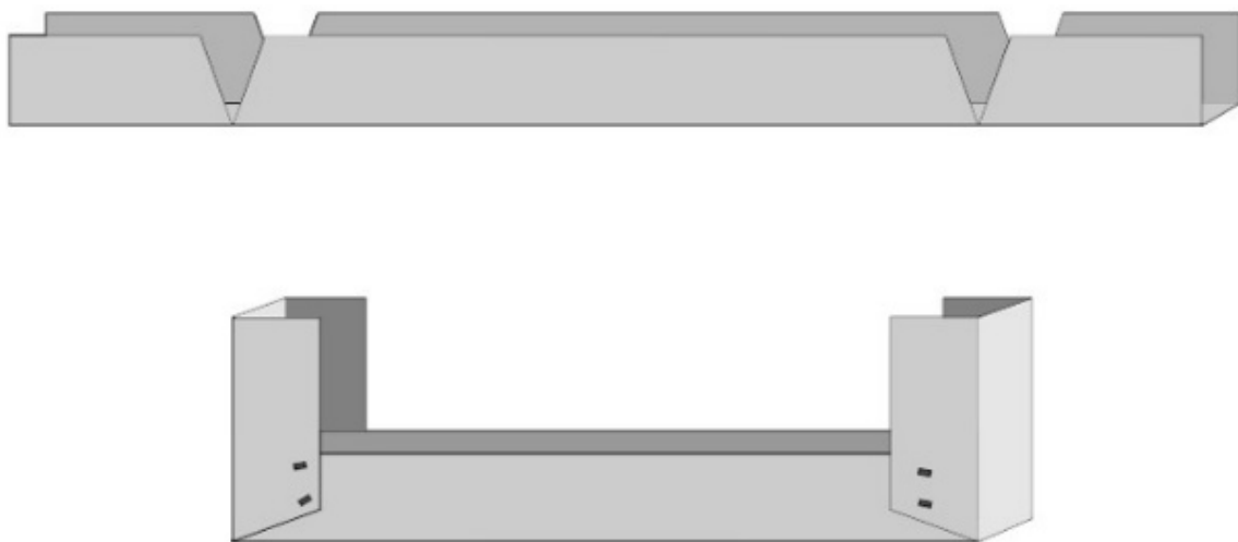
Рис. 6. Изготовление каркаса из профиля ПП 60x27 для смены уровня ОСК
