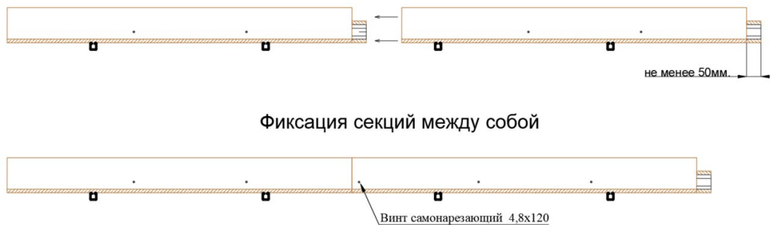
Рис. 12. Фиксация секций короба-лотка между собой
