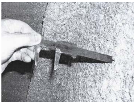
Рис.4. Измерение толщины покрытия штангенциркулем.
