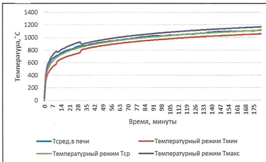
Рис. 1. Температура в печи при испытании образца № 1;
